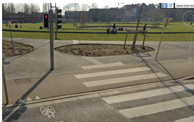
Figure 1: illustration d'aménagement podotactile au carrefour petite ceinture Chaussée de Ninove (google street 2021)
